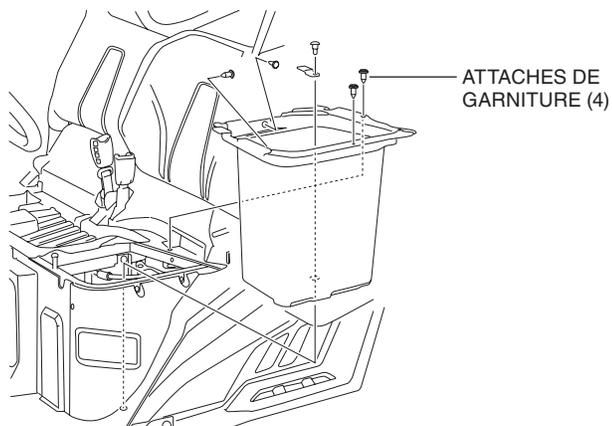
3. Installer le boulon à épaulement dans le support sur le tuyau de soutien en le passant à travers le joint en caoutchouc situé au fond de la boîte, tel que montré.
